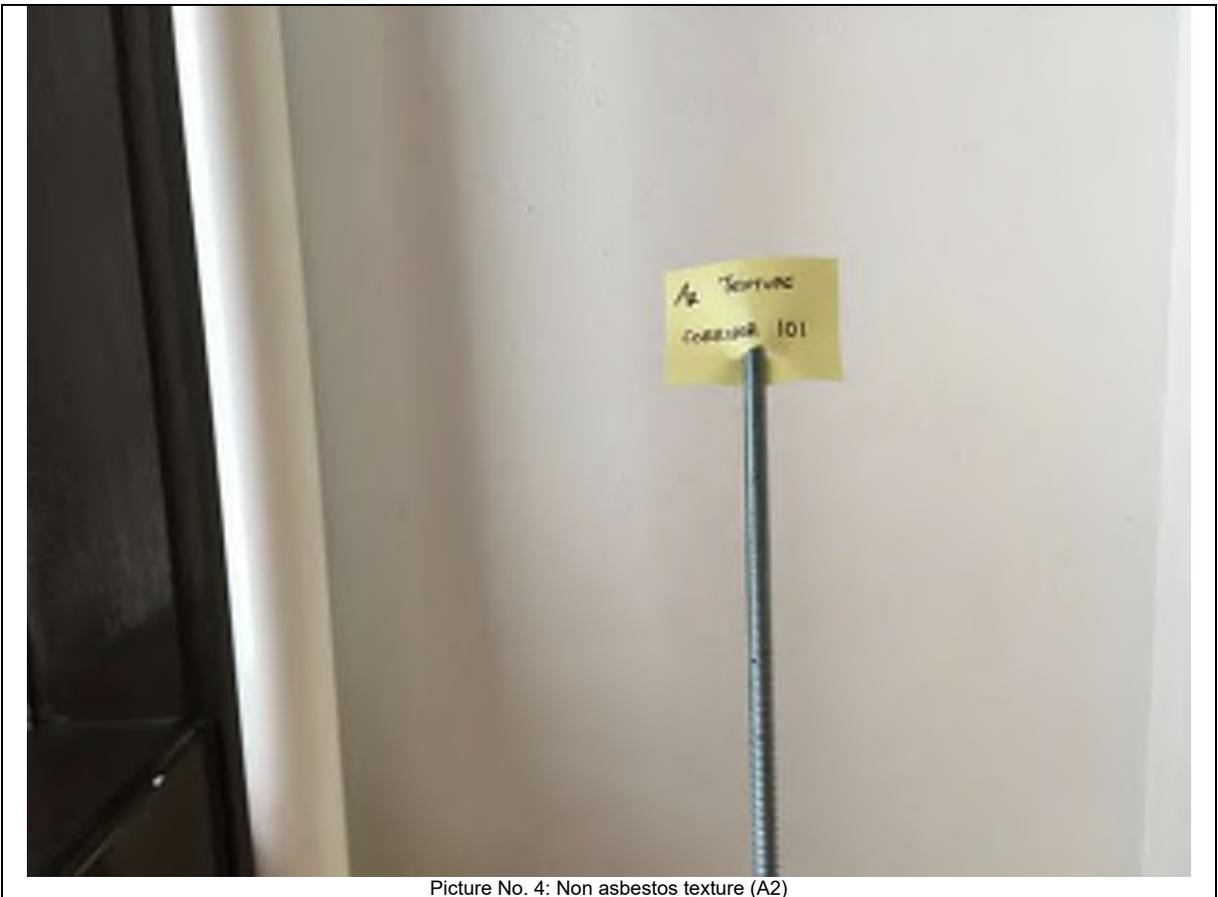
Picture No. 4: Non asbestos texture (A2)
